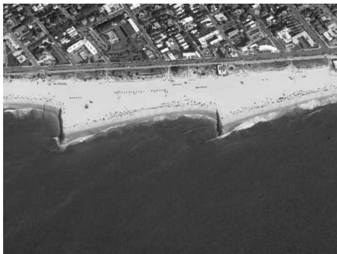
Рис. Аккумуляция наносов и размыв пляжа до и после бун. США, штат Нью-Джерси, Кейп-Мей.
