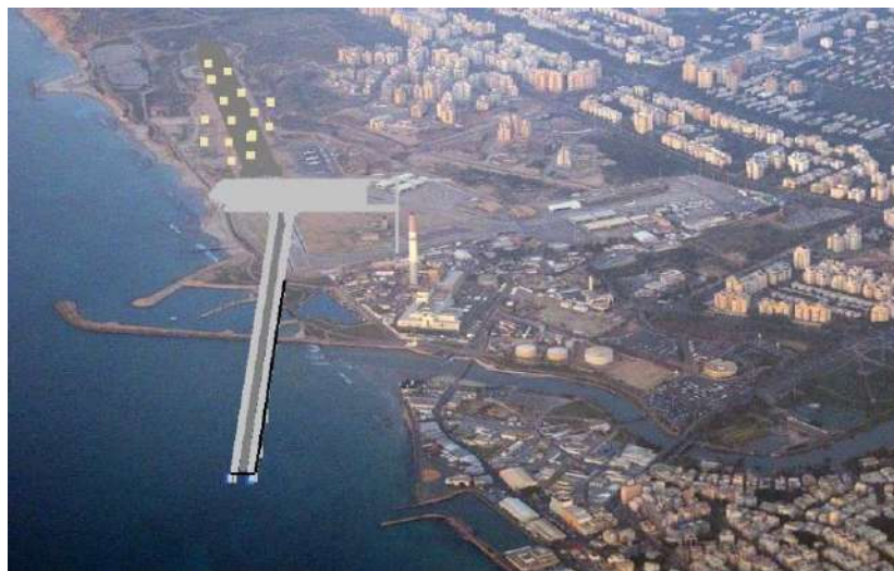
Рис. 1. Предлагаемая взлетно-посадочная полоса аэропорта Сде- Дов, частично расположенная в море на сваях (условно укорочена)
